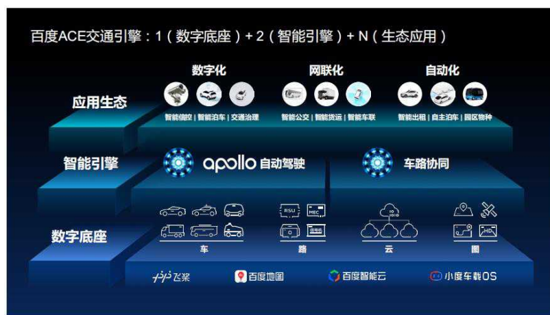
图 4：百度 ACE 交通引擎总体架构
